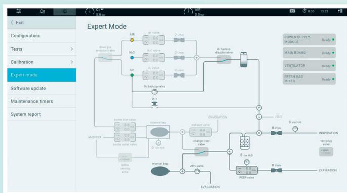
Un contrôle diagnostique complet est effectué au démarrage. Les procédures d'étalonnage sont réalisées automatiquement. Des outils de diagnostic tels que le «Mode Expert» permettent un test supplémentaire des composants sans recourir à des équipements spéciaux. La conception ergonomique de l'architecture pneumatique rend la plateforme plus accessible et le «Journal des événements» détaillé aide à un dépannage efficace.
